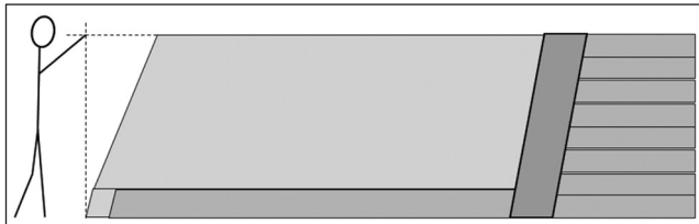
Figura 23. Vista en sección de la toma de medidas del talud
